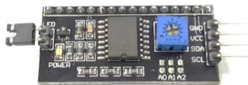
รูปที่ 16.3 แสดงโมดูลสื่อสารแบบ I2C สำหรับขับจอ LCD
