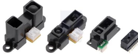
รูปที่ 13.1 แสดงโมดูลวัดระยะทางด้วยแสงอินฟราเรด (GP2) แบบต่างๆ
