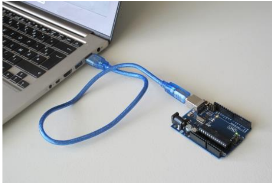
รูปที่ 2.2 แสดงการเชื่อมต่อคอมพิวเตอร์กับบอร์ด Arduino UNO R3
